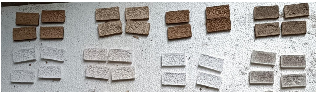
Рис. 3.3 – Плоскі керамічні зразки для випробування на вигин
