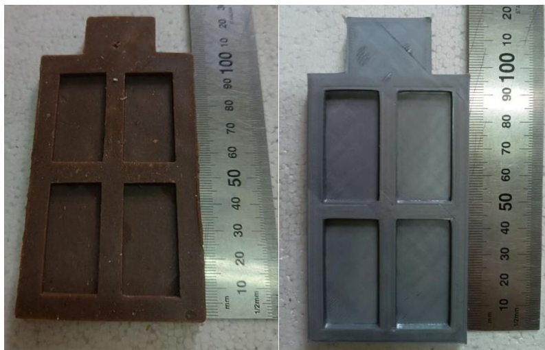
Рис. 2.2 – Воскова (а) та пластикова (б) моделі для виготовлення плоских зразків кераміки
