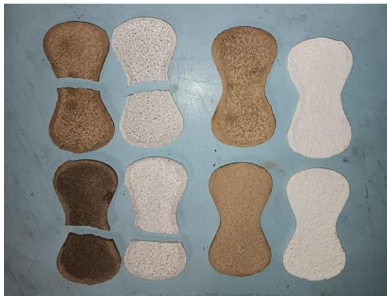
Рис. 3.7 – Керамічні зразки для випробування на розтяг
