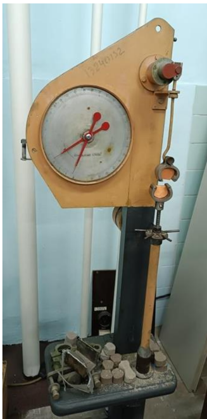
Рис. 2.6 – Загальний вид та схема [22] приладу для вимірювання міцності зразків при розриванні: 1 – станина; 2 – радіальна шкала; 3 – зразок; 4 – сережка; 5, 6 – затискачі; 7 – гвинтовий пристрій; 8 – рукоятка; 9, 10 – стійки; 11 – вантаж
