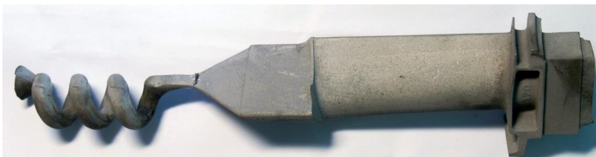
Рис. 4.5. – Зовнішній вигляд лопатки другого ступеню турбіни GT 5000
