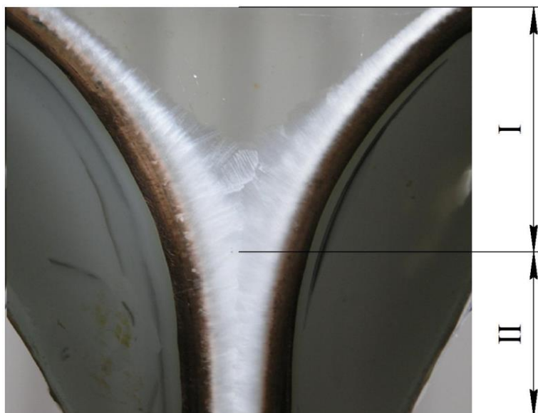
Рис. 3.15 – Одержання листової заготовки з камфену за схемою беззливкової прокатки при фізичному моделюванні: I – зона кристалізації; II – зона прокатки
