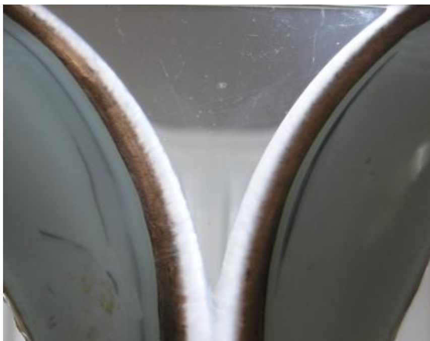
Рис. 3.13 – Формування затверділої кірки розплаву камфену на поверхнях валків-кристалізаторів
