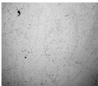
АД35; V_{\text{охол.}} = 152 \text{ }^{\circ}\text{C/s}
