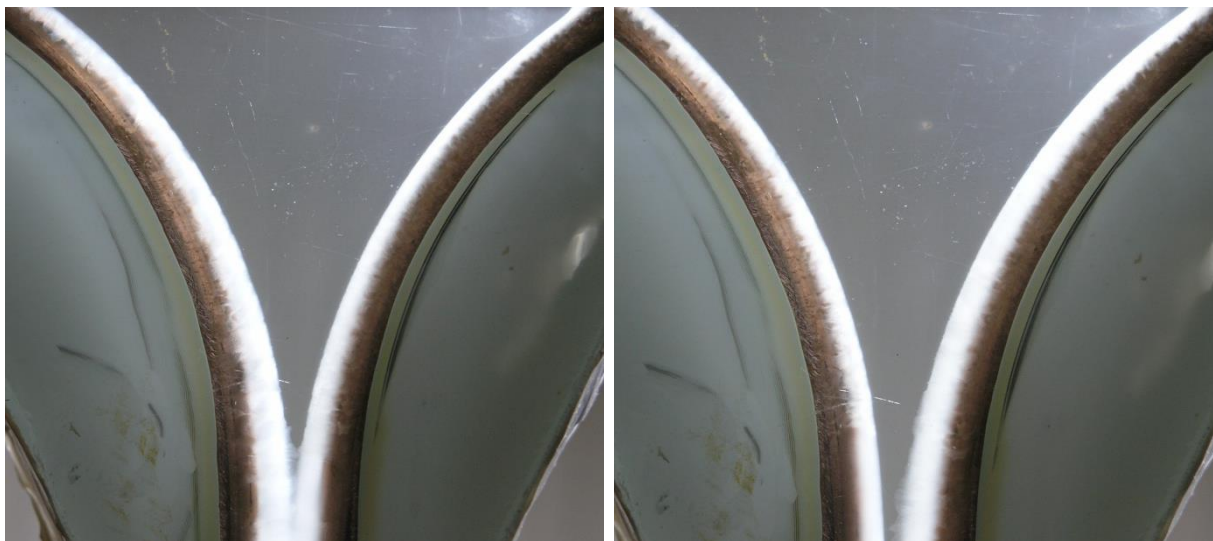
Рис. 3.14 – Товщина затверділої кірки камфена на поверхнях валків-кристалізаторів при асиметричній гідродинамічній картині в рідкій ванні
