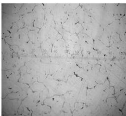
АД35; V_{\text{охол.}} = 2,5 \text{ }^{\circ}\text{C/s}
