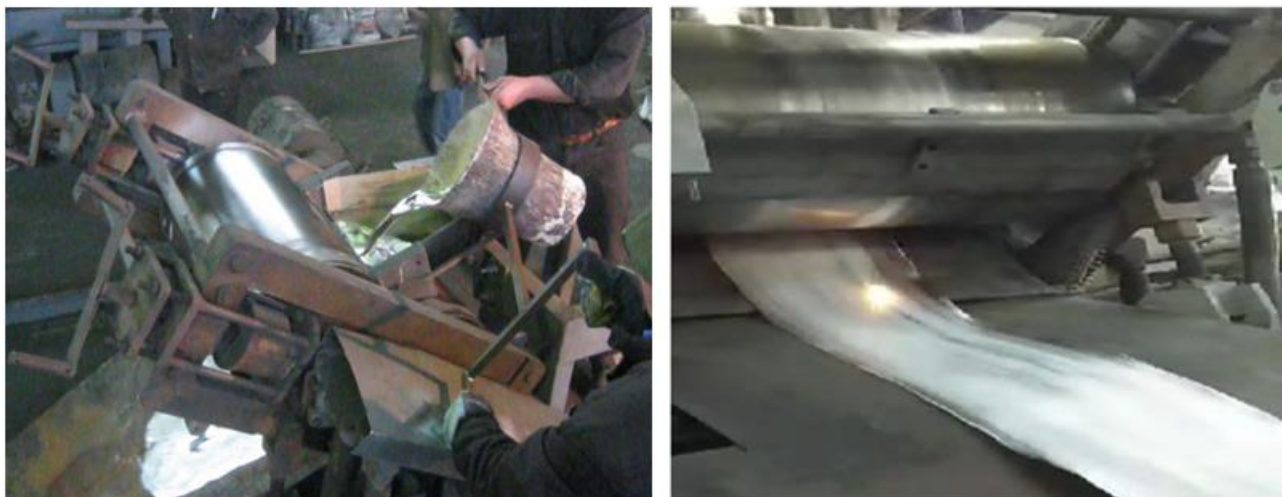
Рис. 4.8 – Лиття листової заготовки на двовалковій лабораторній установці
