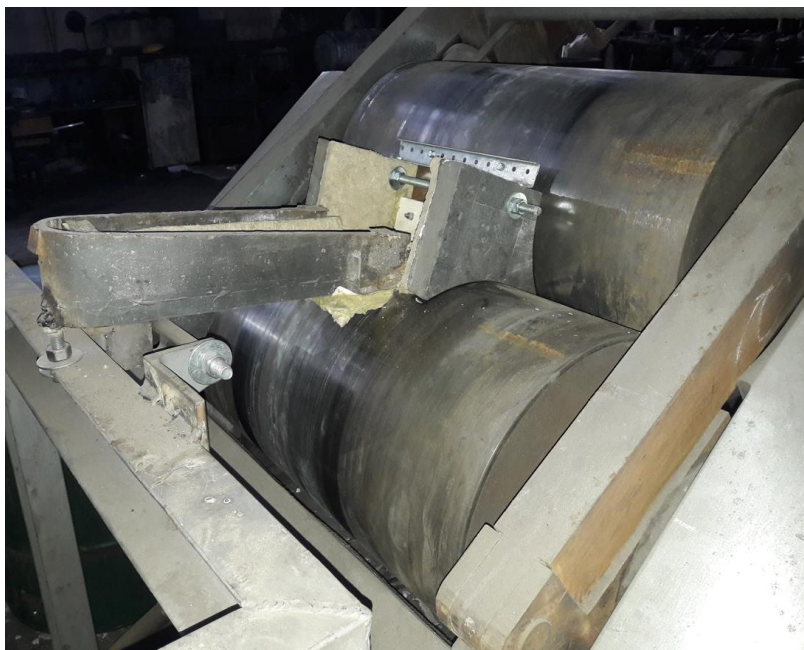
Рис. 2.11 – Проміжний пристрій для заливки металу у валковий кристалізатор
