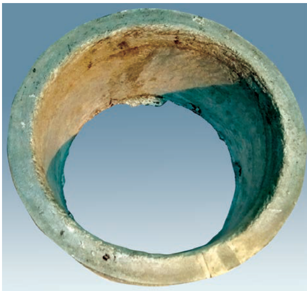
Виливки з алюмінієвих сплавів діаметром 400 мм (ліворуч) та 150 мм, одержані відцентровим литтям
