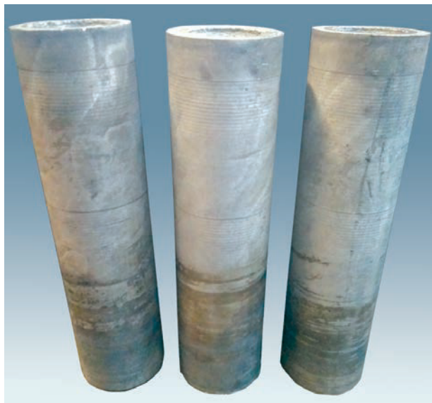
Виливки з алюмінієвих сплавів діаметром 400 мм (ліворуч) та 150 мм, одержані відцентровим литтям
